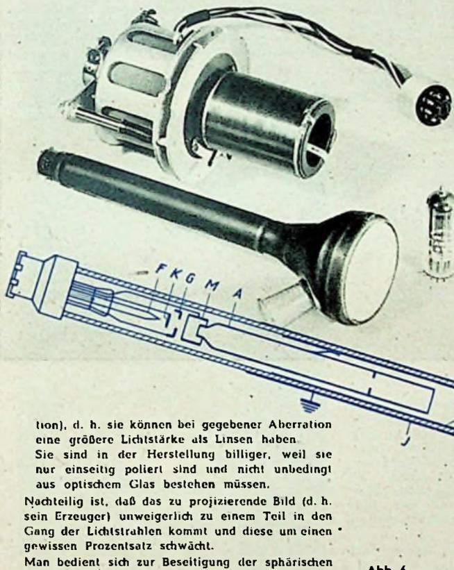
Abb. 6. Schnitt durch die Katodenstrahlröhre MW 6-2
